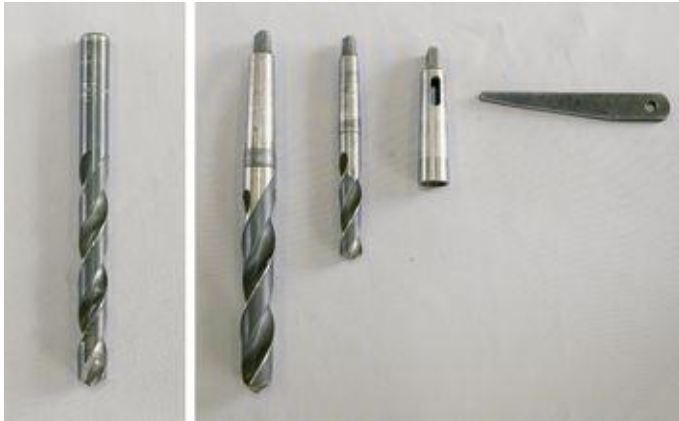
Figuur 1-4: Een spiraalboor met rechte schacht (links) en een spiraalboor met conische schacht, huls en uitdrijver (rechts)
